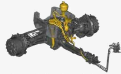
La suspensión del eje delantero funciona en ambos sentidos para aumentar el confort y la tracción.
