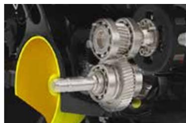
Transferencia directa de potencia del motor a la TdF delantera.
