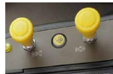
Activación electrohidráulica de las TdF delantera y trasera.
