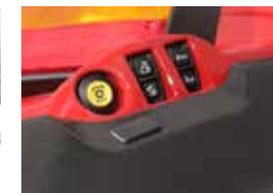
Tanto en la parte delantera del tractor como en la trasera dispone de mandos externos para elevación hidráulica, TdF y una unidad de control adicional.
