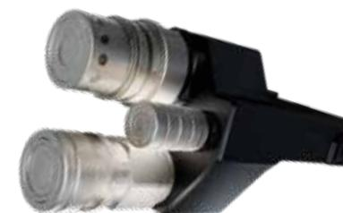
Los motores eléctricos o los implementos con gran demanda hidráulica pueden alimentarse con un máximo de 110 litros de aceite por minuto a través de la conexión Power Beyond.
