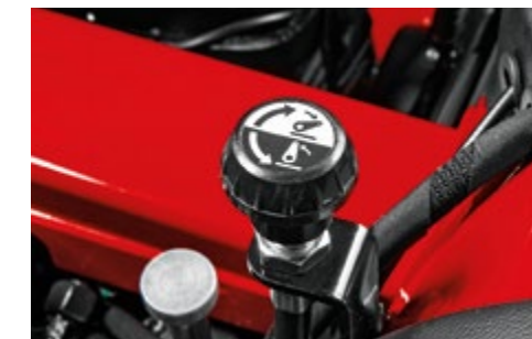
MANDO PARA FIJAR LA SUBIDA MÁXIMA DEL ELEVADOR Aumenta la precisión de trabajo y protege los equipos con cardán.
