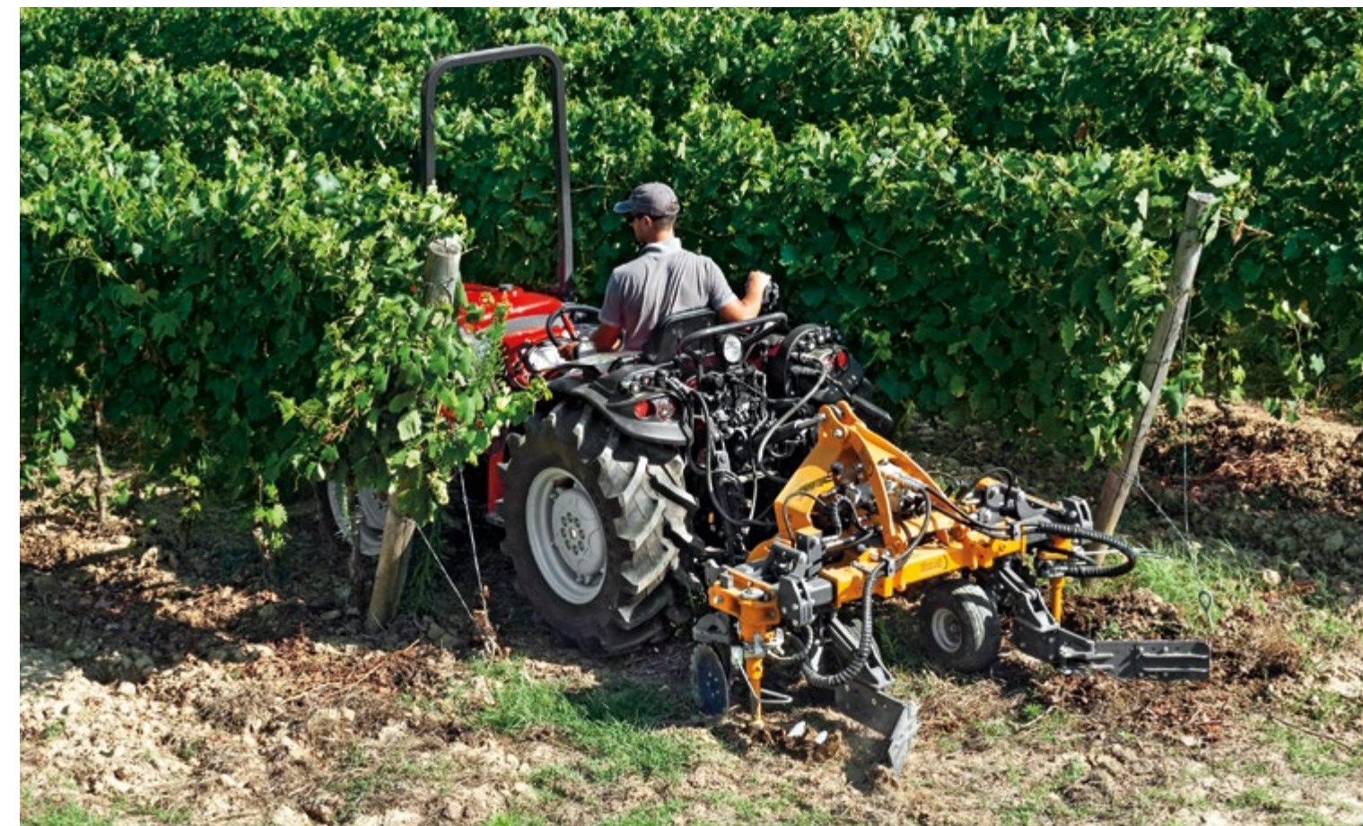
MANDO PARA FIJAR LA SUBIDA MÁXIMA DEL ELEVADOR Aumenta la precisión de trabajo y protege los equipos con cardán.
