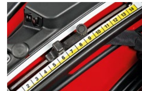
ELEVADOR CON CONTROL DE POSICIÓN Y ESFUERZO Dispositivo de combinación mixta.
