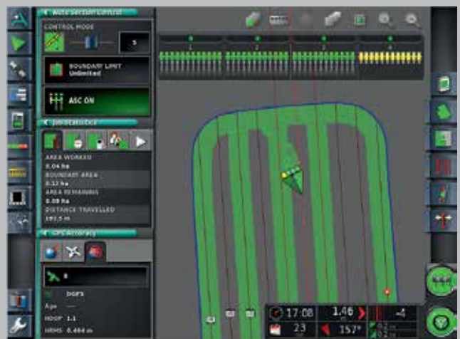
Control de secciones y control de dosificación variable disponibles como opciones.
