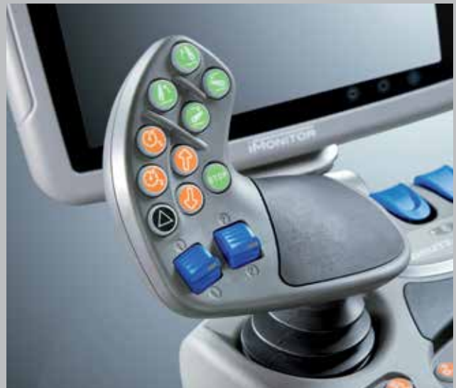
Con solo pulsar dos botones de la palanca multifunción MaxCom, el conductor puede activar cuatro configuraciones de velocidades distintas, tanto en el campo como en la carretera, y mantener una velocidad constante para lograr resultados óptimos.
