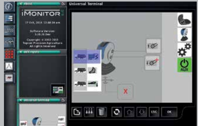
Integración ISOBUS. Las funciones del apero se controlan mediante las teclas definidas del tractor.
