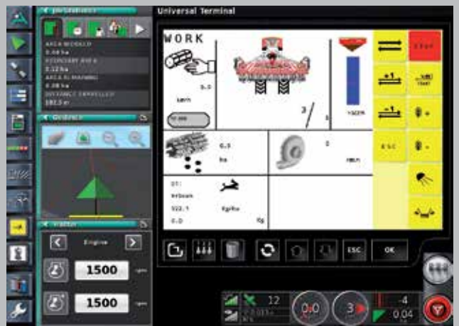
Funciones compatibles con TIM (Tractor Implement Management, sistema de gestión de aperos de tractores) para satisfacer automáticamente las demandas de los aperos.
