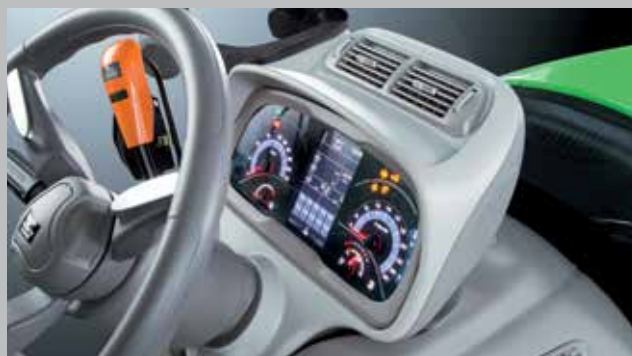
Cuadro de instrumentos de última generación con nuevo InfoCentre pro : pantalla LCD en color de 5" de alta resolución para permitir un concepto de información superior personalizable.
