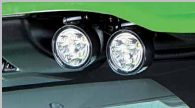
Hasta 16 faros de trabajo led (IV generación, 2500 lúmenes/faro).
