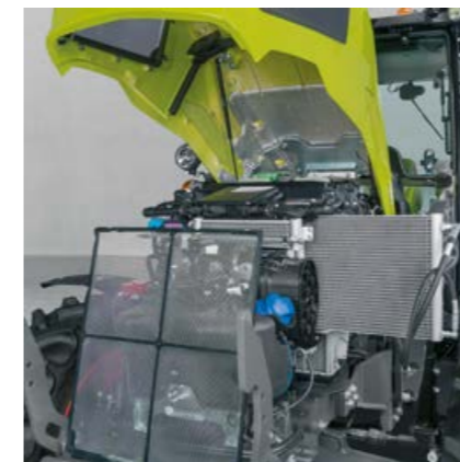
En un momento se puede sacar el radiador y retirar el tamiz del radiador para su control y limpieza.
