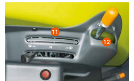
La toma de fuerza es conmutada hidráulicamente de serie. En las máquinas con equipamiento REVERSHIFT se ofrece opcionalmente la conmutación electrónica de la toma de fuerza.
