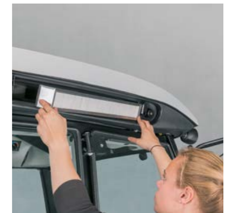
El filtro de aire de la cabina ofrece un fácil acceso para ser limpiado desde el exterior y garantiza, en todo momento, un clima fresco.
