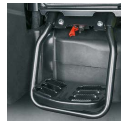
El interruptor de desconexión de la batería está colocado a mano en la entrada izquierda. (a excepción de ELIOS 210)
