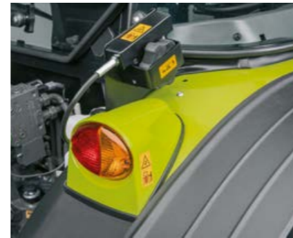
El reglaje mecánico del elevador trasero puede ser manejado externamente en la parte trasera para el montaje de aparatos.
